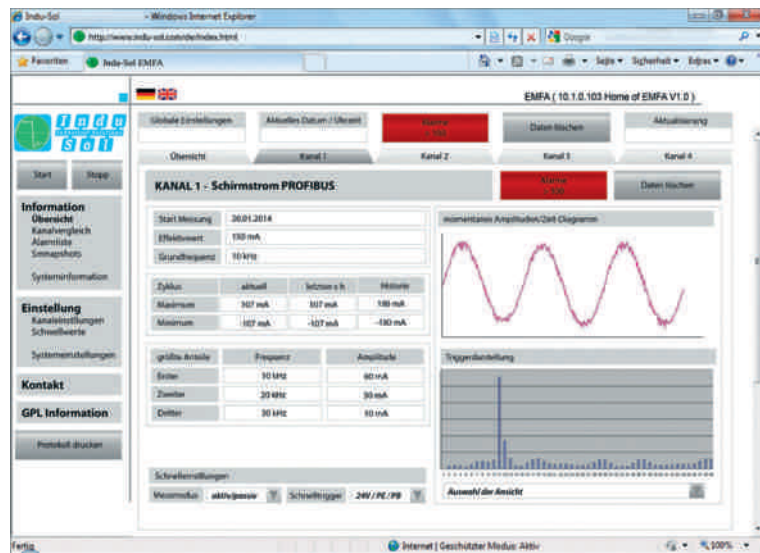
Die Weboberfläche des EMV-INSPEKTOR V2 gibt eine Übersicht über Störungen. Hier können über vier Kanäle gleichzeitig Analysen durchgeführt und Aussagen über Art und Frequenz der Störanteile gemacht werden.
