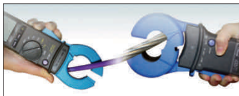
Die Leckstrommesszange LSMZ I (li.) gibt Auskunft zur Belastung des Potenzialausgleichsystems. Mit der Maschenwiderstandsmesszange MWMZ I (re.) hingegen wird die Güte des Potenzialausgleichs (Impedanzwerte bei 2,2 kHz) messbar.
