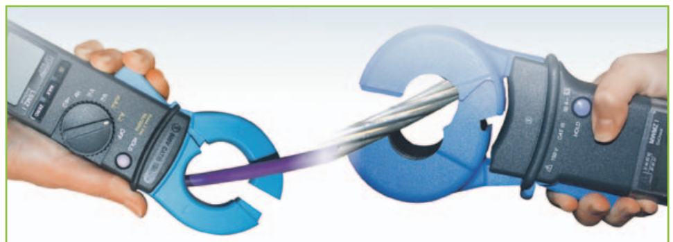
Bild 3. Die Leckstrom-Messzange ( links ) gibt Auskunft zur Belastung des Potenzialausgleichs-Systems. Mit der Maschenwiderstandsmesszange ( rechts ) hingegen wird die Güte des Potenzialausgleichs (Impedanzwerte bei 2,2 kHz) messbar.
