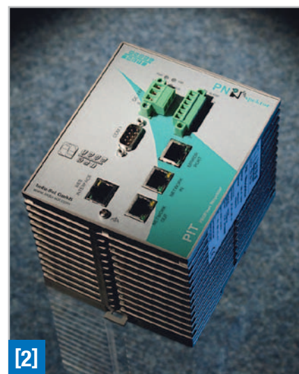
[2] Die intelligente Analyse des logischen Telegrammverkehrs bildet die Basis für die Zustandsanzeige im Topologieplan.
