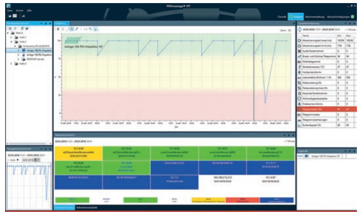
Bild 2: PROManage® NT führt die von den INSPEKTOR® ermittelten Zustandsdaten aus mehreren Netzwerken zentral auf einem Server zusammen. Neben den INSPEKTOR® können auch die im Netzwerk verbauten managebaren Switches ausgelesen werden.
