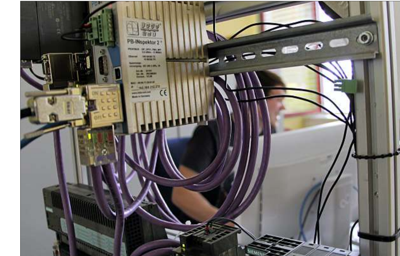
Diagnosegerät für automatisierte Maschinen: Der Profibus-Inspektor wurde in der Blumenstraße 3 in Schmölln erdacht.
