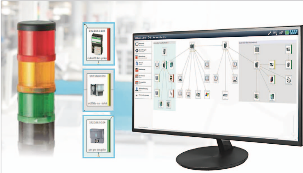
Bild 1: Die Topologie-Software zeigt nicht nur, wo genau sich die Teilnehmer in ihrer Anlage befinden, sondern auch deren Gesundheitszustand. Dieser wird mittels Ampelfarben grafisch angezeigt. (Foto: Indu-Sol)
